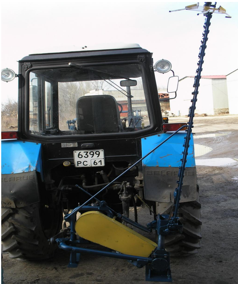
Рис.3 Косилка КСЛ-2,1 в транспортном положении
