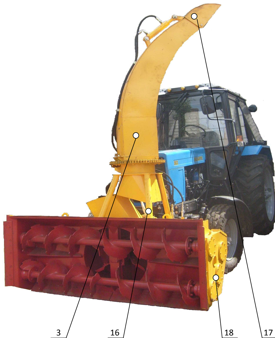
Рис.3. Шнекороторный снегоуборочный комплекс ШРК-2,0 с установкой на базовый трактор.
