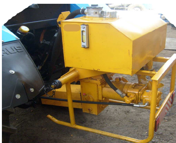
Рис.4. Узел привода ГХУ и вращения Ротора.
